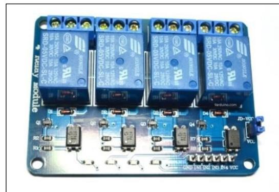
รูปที่ 7 Module relay
